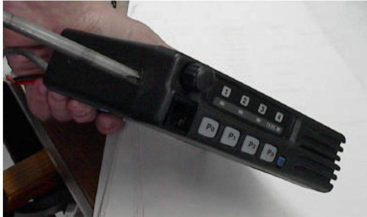
4) Con cuidado se procede a retirar la parte frontal del radio y se levanta una hoja metálica de protección en el equipo de radio, debajo de la cual está el punto que nos interesa para realizar la modificación.
