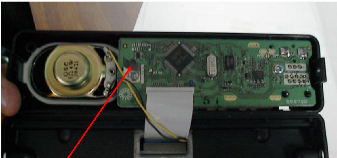
Lámina a levantar (con Precaución)
